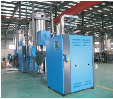
由于PE含水率较高,在高温挤出熔融时会产生气泡、龟裂、色泽发黄等不良缺陷。在PE的系统应用中,除湿干燥为最主要的制程,除湿干燥的效果对产品质量起着决定性的作用。我们能为广大PE注塑设备和产品生产厂家提供可靠的除湿干燥技术保障。
